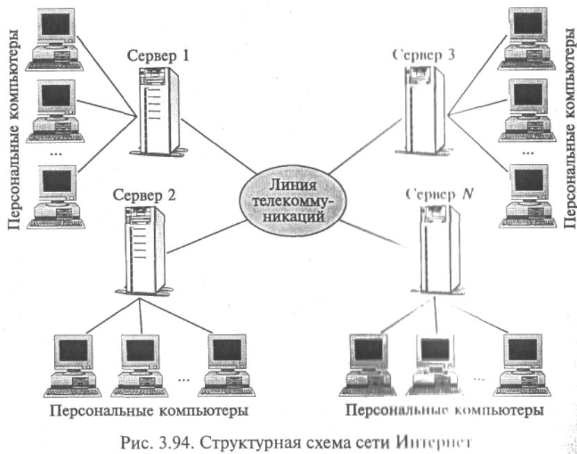
Рис. 3.94. Структурная схема сети Интернет
